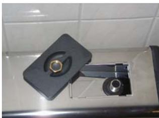
Пластмассовая крышка и трубка, используемые при процедурах удаления накипи
